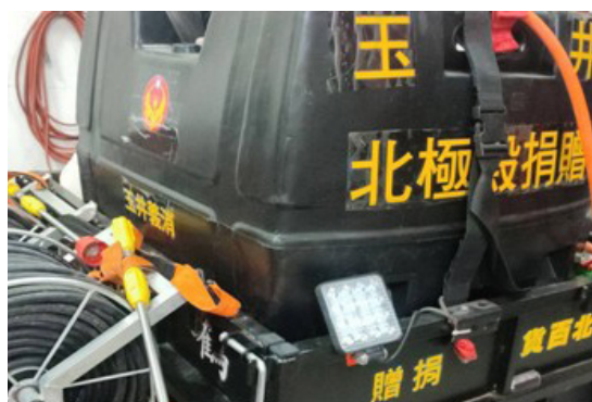
圖 4、300 公升儲水桶、兩捲水線、夜間照明 LED 燈
